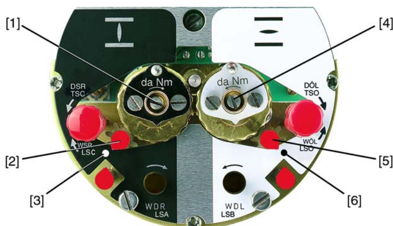
рис. 68: Регулировочные элементы концевого выключателя
