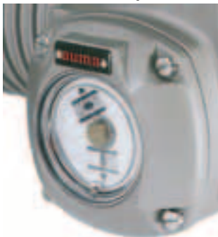
Рис. М2: Снятие диска указателя положения
