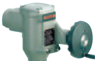
Неполноповоротный привод AS 6 – AS 50 крутящий момент от 25 до 500 Нм время позиционирования дл 90° от 4 до 90 сек.
