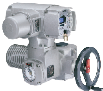
Полноповоротный привод SA/ SAR с узлом управления AUMATIC крутящий момент от 10 до 1000 Нм число оборотов от 10 до 180 в мин. -1
