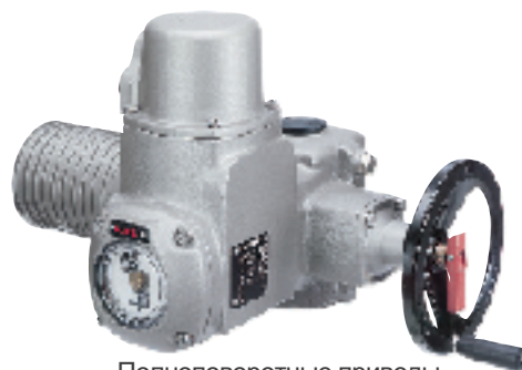
Полноповоротные приводы SA 07.1 – SA 16.1 / SA 25.1 – SA 48.1 крутящий момент от 10 до 32000 Нм Число оборотов от 4 до 180 в мин. -1
