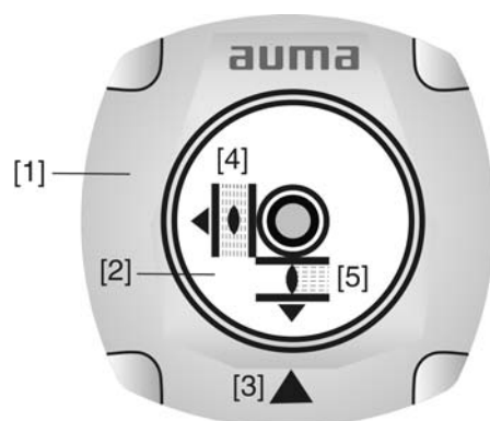
рис. 26: Механический указатель положения
