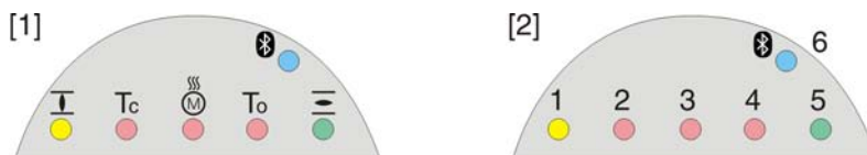
рис. 57: Расположение ламп и описание ламповой индикации
