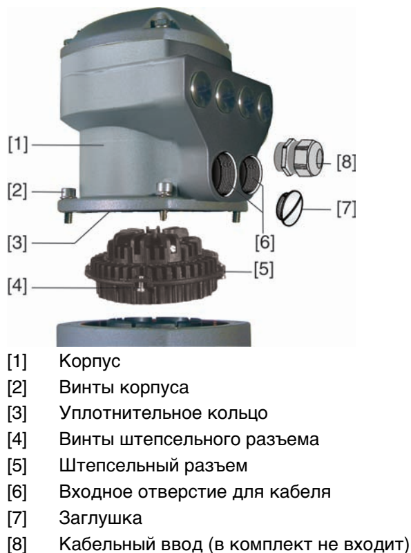
рис. 13: Штепсельный разъем AUMA SD-шины
