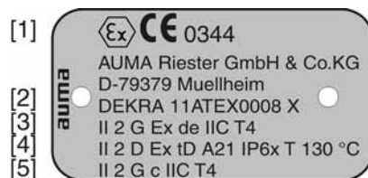
рис. 4: Сертификационная табличка. Исполнение во взрывозащищенном корпусе
