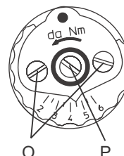
Рисунок L: Головки моментных выключателей
