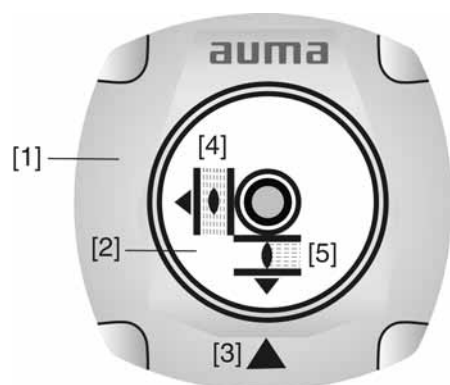
рис. 31: Механический указатель положения
