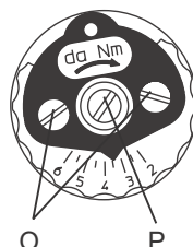
Рисунок L: Головки моментных выключателей
