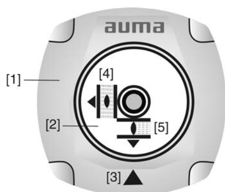
рис. 36: Механический указатель положения
