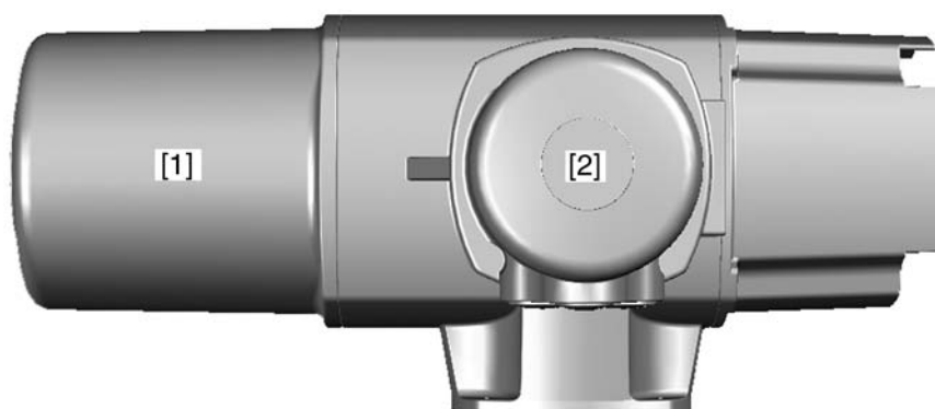
рис. 54: Доступ к предохранителям
